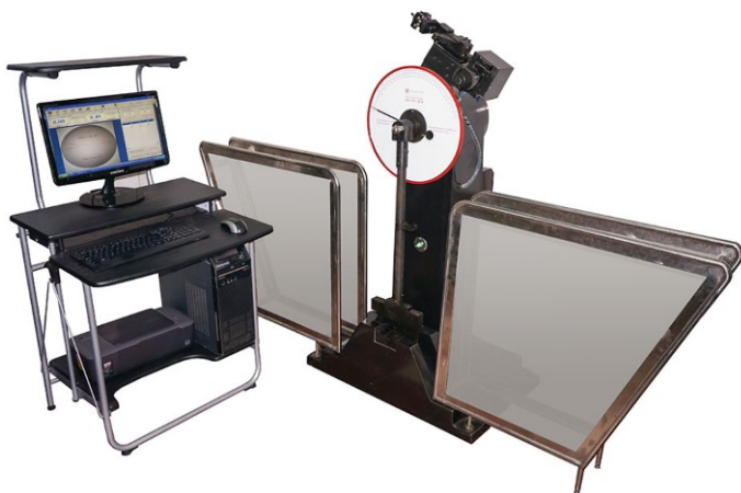
Рис. 6.1 – Маятниковий копер для механічних випробувань на ударний згин (визначення ударної в'язкості)
