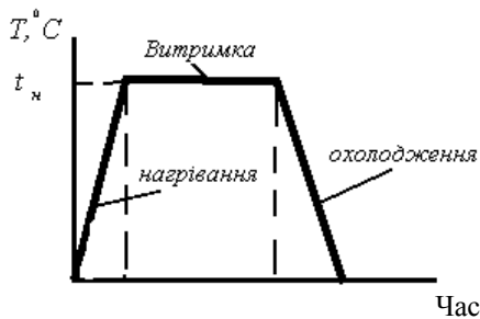
Рис. 5.4 – Графік режиму термічної обробки ( t_n – оптимальна температура нагрівання)
