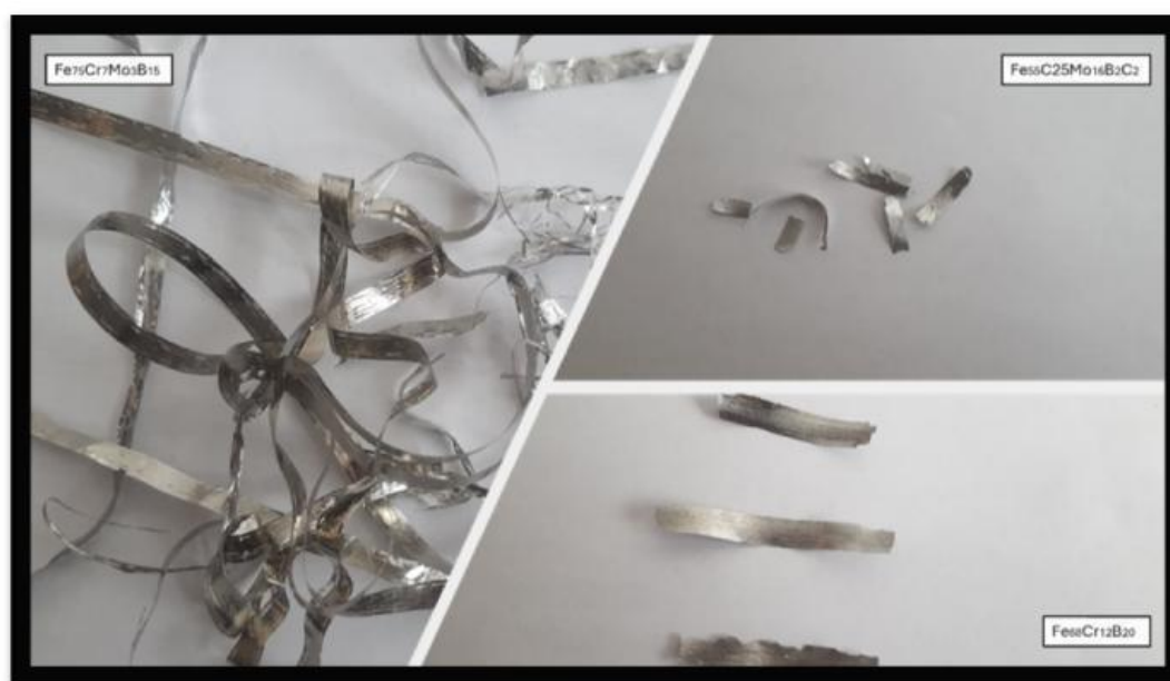
Rys. 2. Zdjęcia makroskopowe odlanych taśm dla stopów: a) Fe_{75}Cr_7Mo_3B_{15} , b) Fe_{55}Cr_{25}Mo_{16}B_2C_2 , c) Fe_{68}Cr_{12}B_{20}
