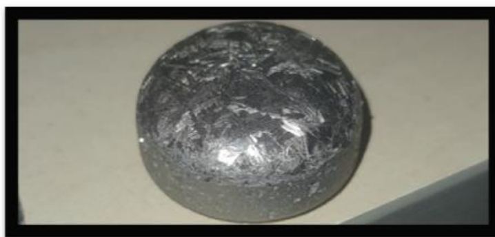
Rys. 1. Przykładowy wstępny odlew po przetapianiu indukcyjnym
