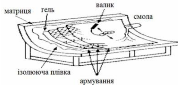
Рис. 1. Метод ручного укладання.
