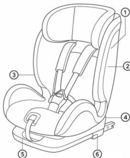
Рис. 1. Основні елементи конструкції дитячого автомобільного крісла: 1 – каркас; 2 – енергопоглинаючі елементи; 3 – система утримання; 4 – підголівник і спинка; 5 – м'яке сидіння і чохол; 6 – система кріплення до кузова автомобіля.
