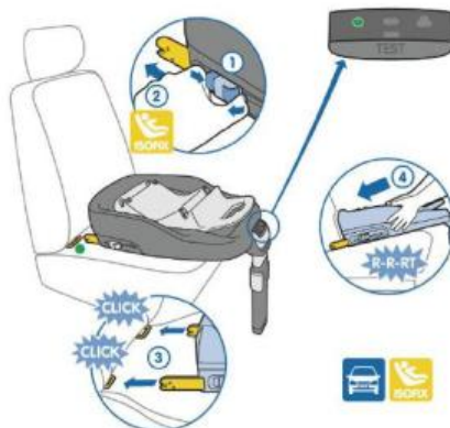
Рис. 2. Схема встановлення система ISOFIX.
