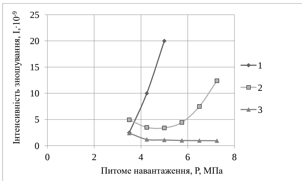
Рис. 2. Залежність інтенсивності зносу від питомого навантаження для металополімерних композиційних матеріалів, наповнених твердими мастилами: 1 – ПТФЕ+мідь+ \text{MoS}_2 ; 2 – ПТФЕ+мідь+ \text{MoSe}_2 ; 3 – ПТФЕ+мідь+ \text{NbSe}_2
