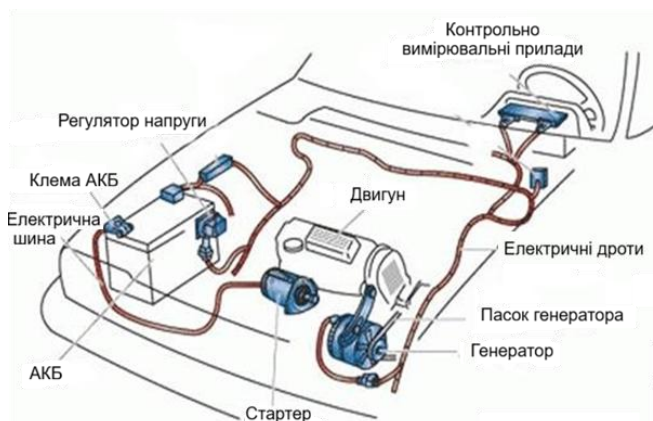
Рис. 1 Система електропостачання автомобіля
